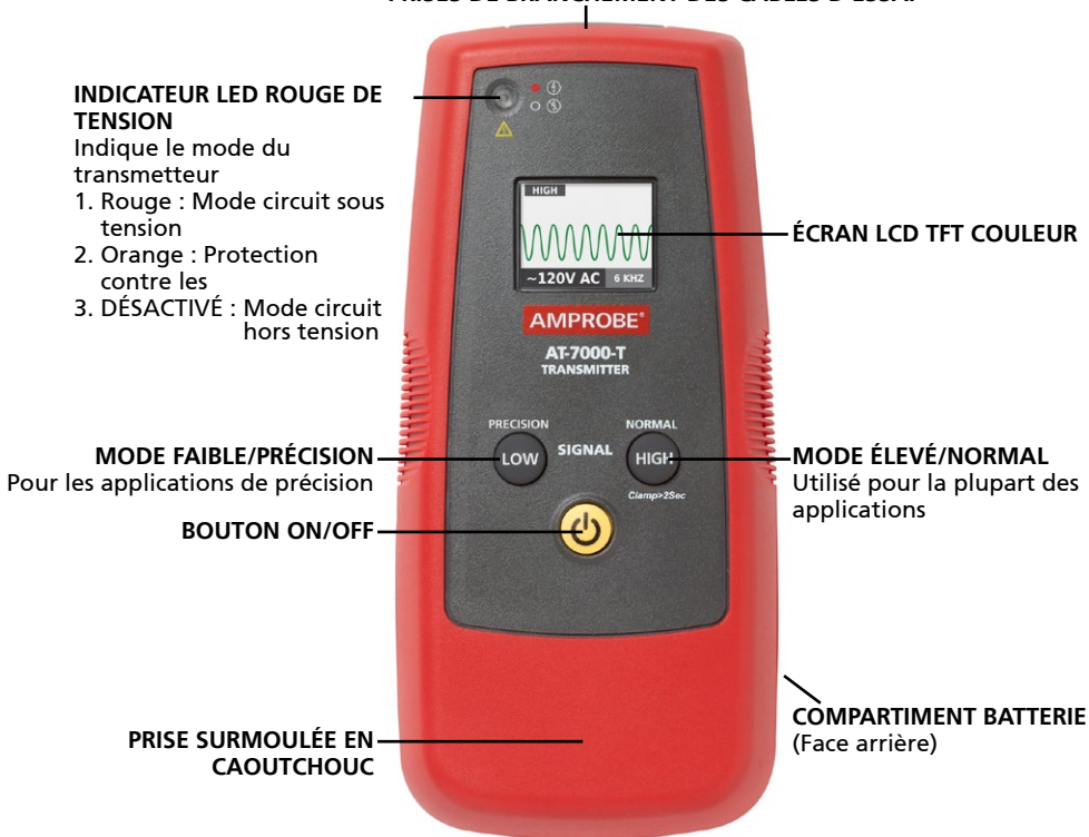
Figure 2 : Vue d'ensemble du transmetteur AT-7000-T
